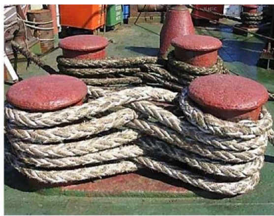
Рисунок 3.34 - Крепление швартовного троса на кнехте
