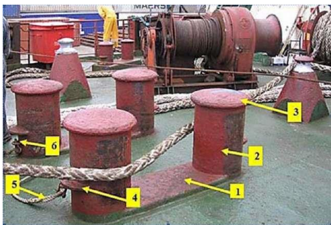
Рисунок 3.33 – Кнехты 1 - основание; 2 - тумба; 3 - шляпка; 4 - прилив; 5 - стопор; 6 - обух
