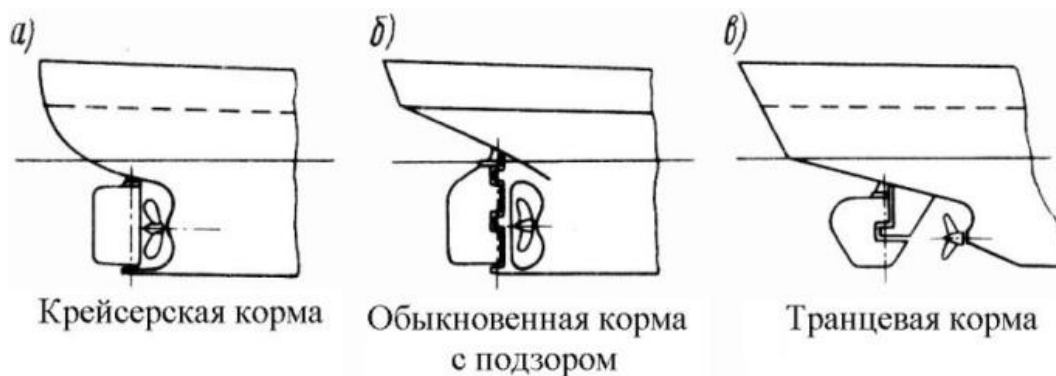
Рис. 1.3. Типовые формы кормовой оконечности морских судов
