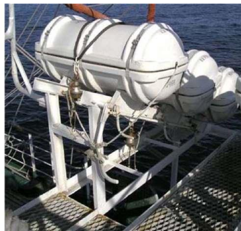
Рисунок 4.7 - Схема крепления ПСН к судну: 1 - найтов; 2 - глаголь-гак; 3 - пусковой линь; 4 - гидростат; 5 - слабое звено; 6 - бандажная лента
