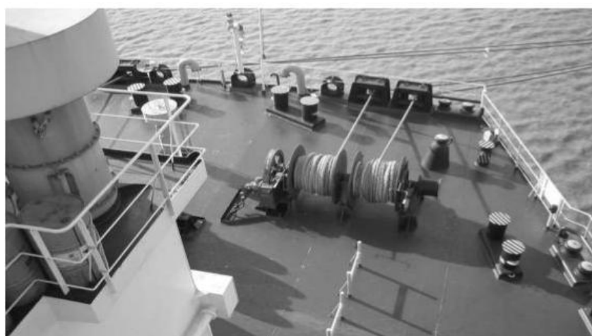
Рисунок 3.37 - Двухбарабанная швартовная лебедка с гидроприводом
