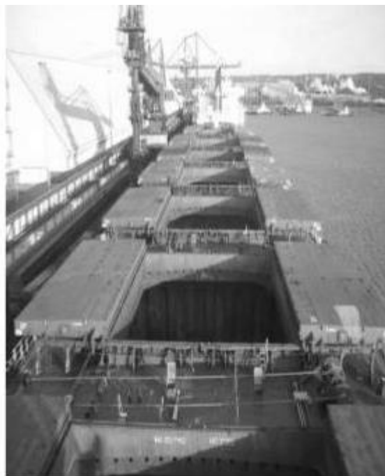
Рисунок 3. 43 -Люковые закрытия крупного балкера, сдвигающиеся к бортам
