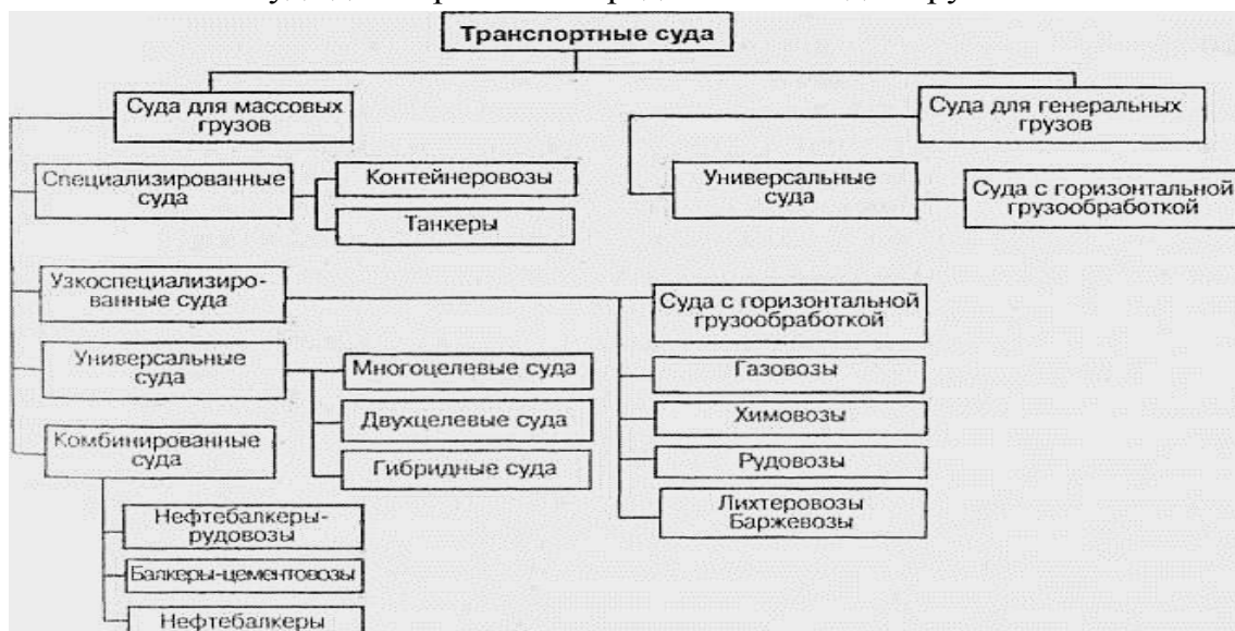
Рисунок 1.6 - Классификация транспортных судов по назначению
