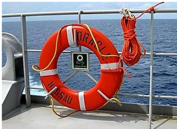
Рисунок 4.10 - Спасательные круги со спасательным линем и с самозажигающимся огнем
