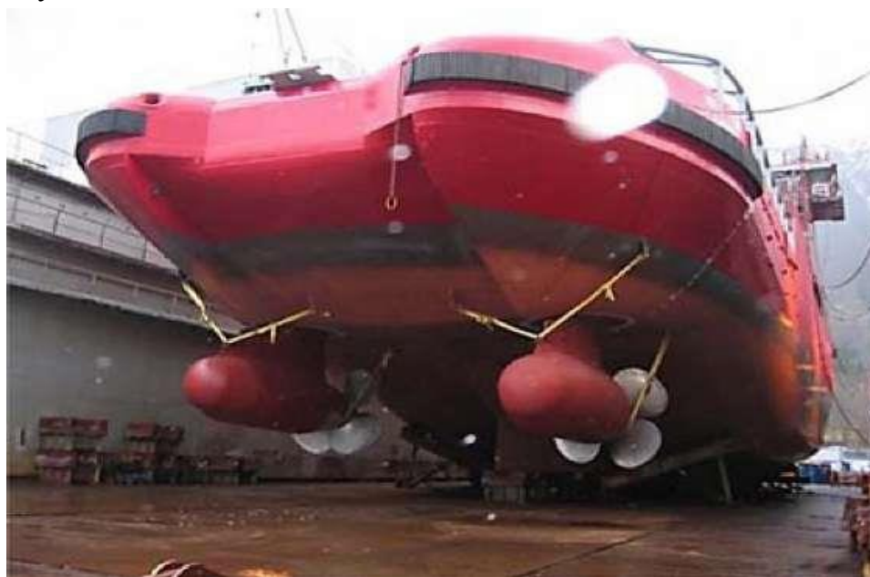
Рисунок 3.25 - Винторулевые колонки типа - AZIPOD.
