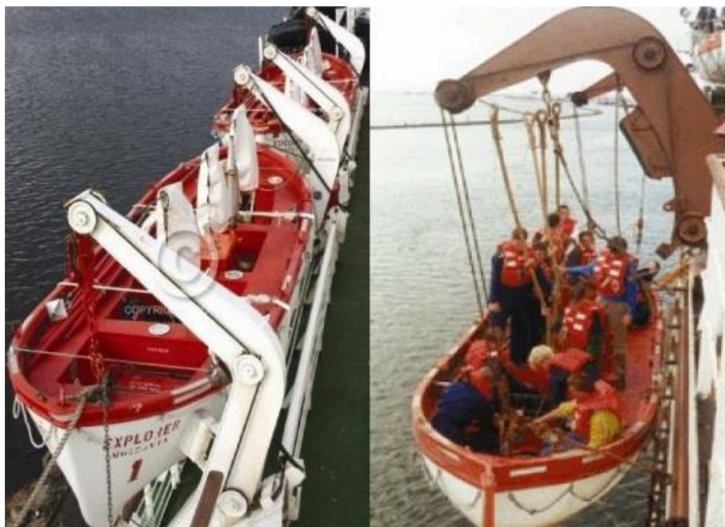
Рис. 2.6. Спасательная шлюпка на гравитационных шлюпбалках
