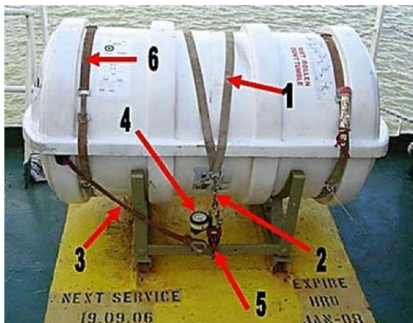
Рисунок 4.7 - Схема крепления ПСН к судну: 1 - найтов; 2 - глаголь-гак; 3 - пусковой линь; 4 - гидростат; 5 - слабое звено; 6 - бандажная лента
